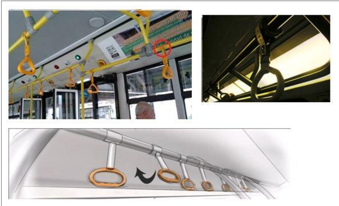
**Figura N°9: Referencia Asideros Flexibles de Anclaje Fijo al Soporte**
