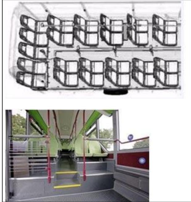
**Figura N°13: Referencia Plataforma Homogénea y Continua**
