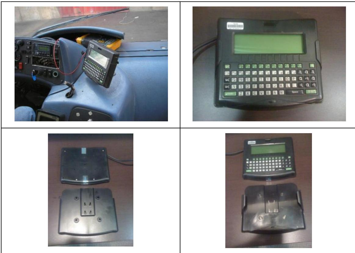
**Figura N°20: Fotos de la consola y su elemento de sujeción**
