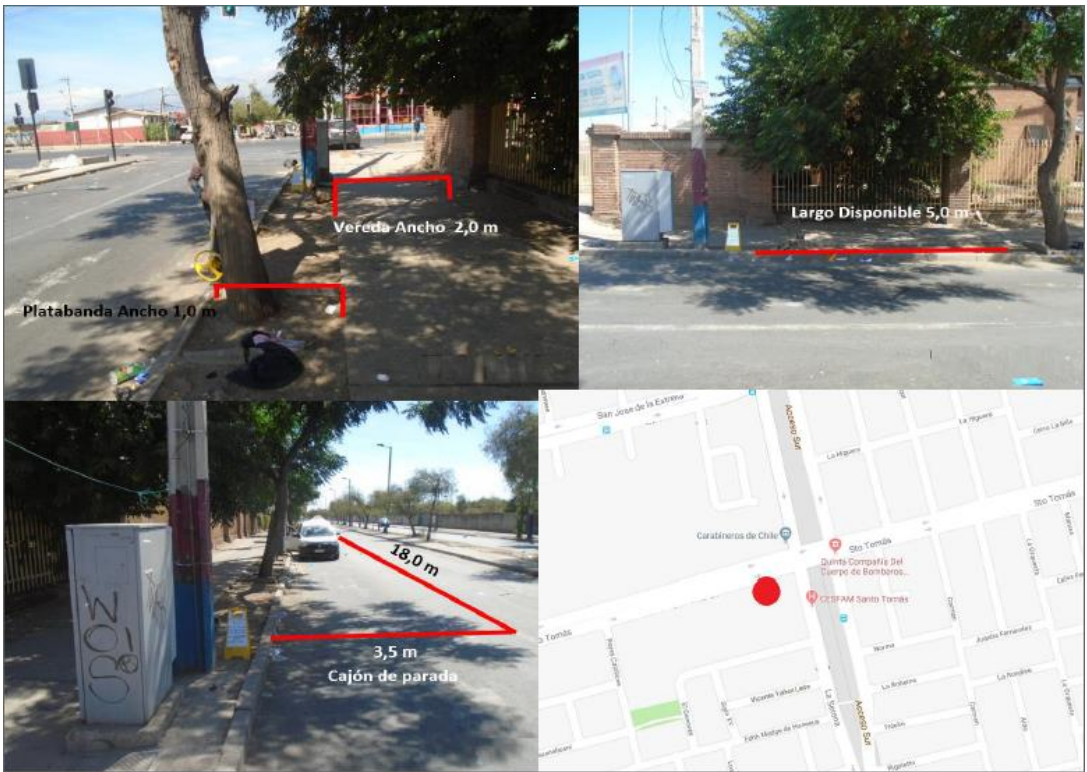
Figura 4: Ejemplo de catastro fotográfico y ubicación Nuevo Punto ID 1
