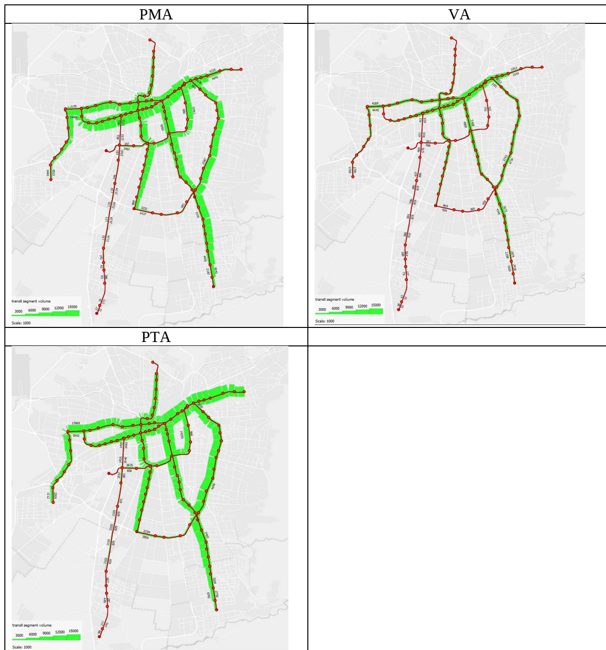
Figura 49. Diagramas de carga en las líneas del metro y del tren sin Línea 3
