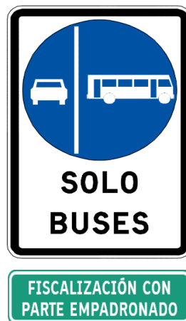
Figura N° 7: Señal RO – 11a con placa adicional verde correspondiente a la Señal Informativa.
