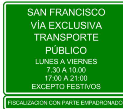
Figura N° 15: Señal con placa adicional verde correspondiente a la Señal Informativa.
