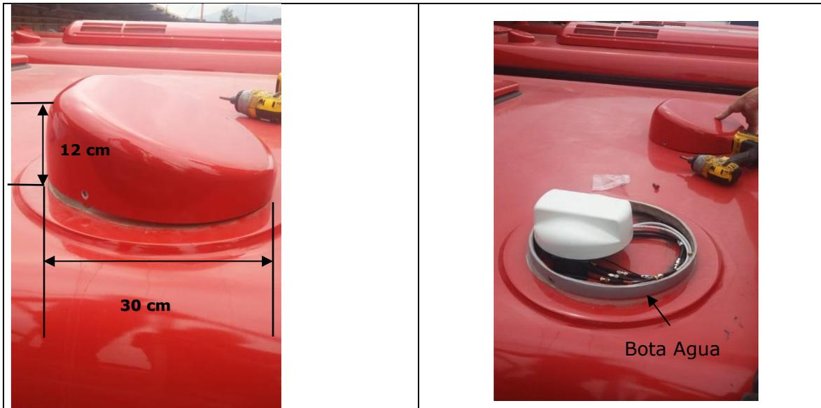
Figura N°4: Domos para las antenas Antena 5 en 1 y Antena 2 en 1
