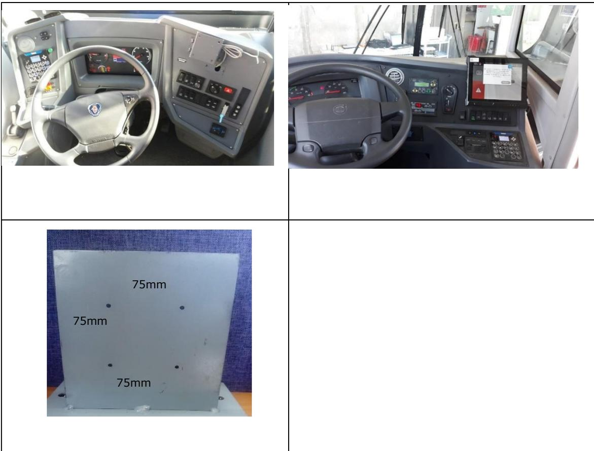
Figura N°11: Fotos de la consola y su elemento de sujeción.
